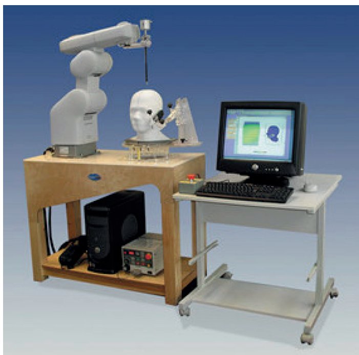
Robotmätning av SAR fördelningen från en mobiltelefon.
